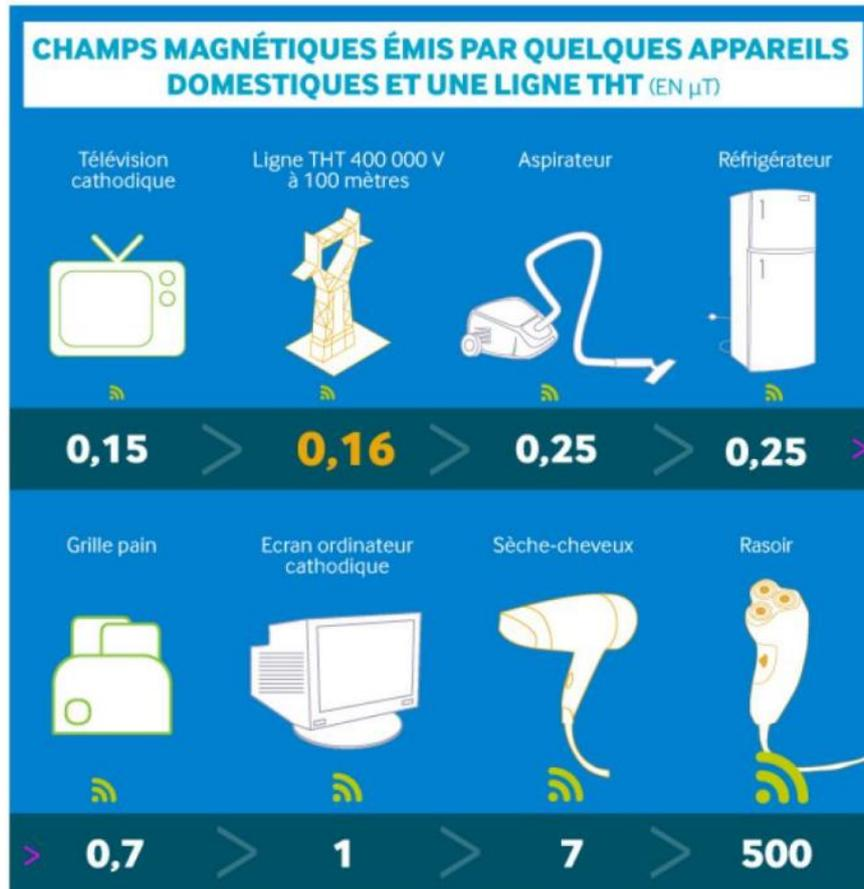
Figure 24 Exemple de champs électromagnétiques
