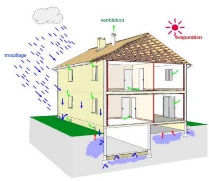
Les bâtiments modernes sont conçus comme des « boîtes ventilées », dont l'enveloppe est imperméable à l'eau et à l'air, et la ventilation est régulée et indépendante des conditions climatiques. Ce principe constructif permet aux occupants des locaux de bénéficier d'un bon confort thermique en maîtrisant les déperditions d'énergie, sauf au niveau des éventuels ponts thermiques.
