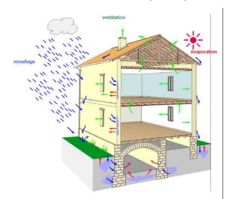
Les bâtiments anciens sont conçus comme des « systèmes respirant », dont l'enveloppe est imperméable à l'eau mais perméable à l'air, et la ventilation, variable en fonction des conditions climatiques, est importante. Ce principe constructif qui fonctionne très bien présente l'avantage de ne pas créer de ponts thermiques.
