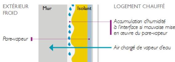
En fonction du matériau composant les murs, le transfert d'humidité de l'extérieur vers l'intérieur et de l'intérieur vers l'extérieur pourra être plus ou moins important. Il faudra en tenir compte pour choisir l'isolant qui convient à votre bâtiment et prendre, le cas échéant, des précautions pour protéger les murs de l'accumulation d'humidité.
