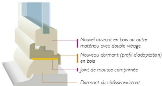
**Rapide et sans dommage** pour l'environnement immédiat de la baie (enduit, papier peint, baguette de finition, etc.), il nécessite toutefois un **bon état du dormant** de l'ancienne fenêtre. Il est réalisé en mettant en œuvre par recouvrement sur ce dormant une **nouvelle fenêtre complète** (dormant + ouvrant), en PVC, en aluminium ou en bois.
