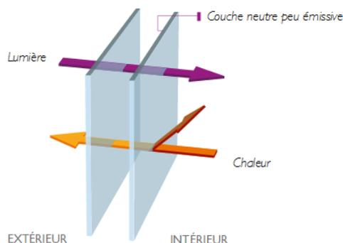
Le double vitrage peut **permettre des économies de chauffage** de l'ordre de **10%** et améliore fortement les conditions de confort en faisant disparaître l'effet de paroi froide.
