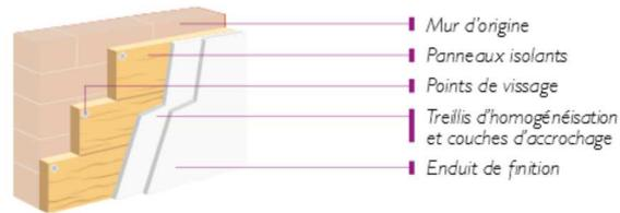
Les **panneaux isolants** sont **fixés** au mur **par collage** et/ou **vissage**. Ils sont recouverts d'un **treillis collé** puis d'un **enduit de finition**. C'est la solution la moins chère en isolation par l'extérieur.
