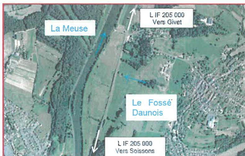
Il s'agit de dériver le cours d'eau « Fossé Daunois », intercepté au km 146.033 de la ligne ferroviaire IF 205 000 allant de Soissons à Givet. Ces travaux restitueront au cours d'eau un écoulement plus naturel par un linéaire proche de son tracé antérieur à la création de la voie ferrée.
