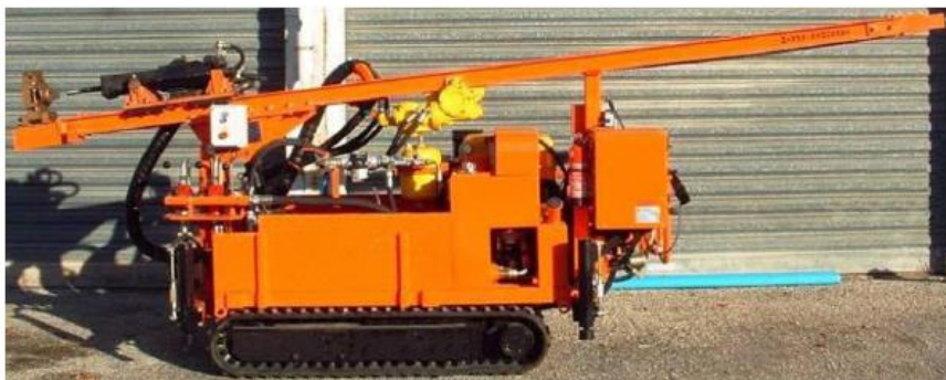
Figure 23 : Sondeuse de type wagon drill hydraulique, Source : FONDASOL
