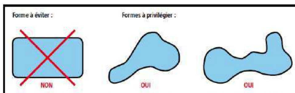
Figure 23 : Formes à éviter et à privilégier pour les mares [2/2] (Source : GTAGZH, 2012)
