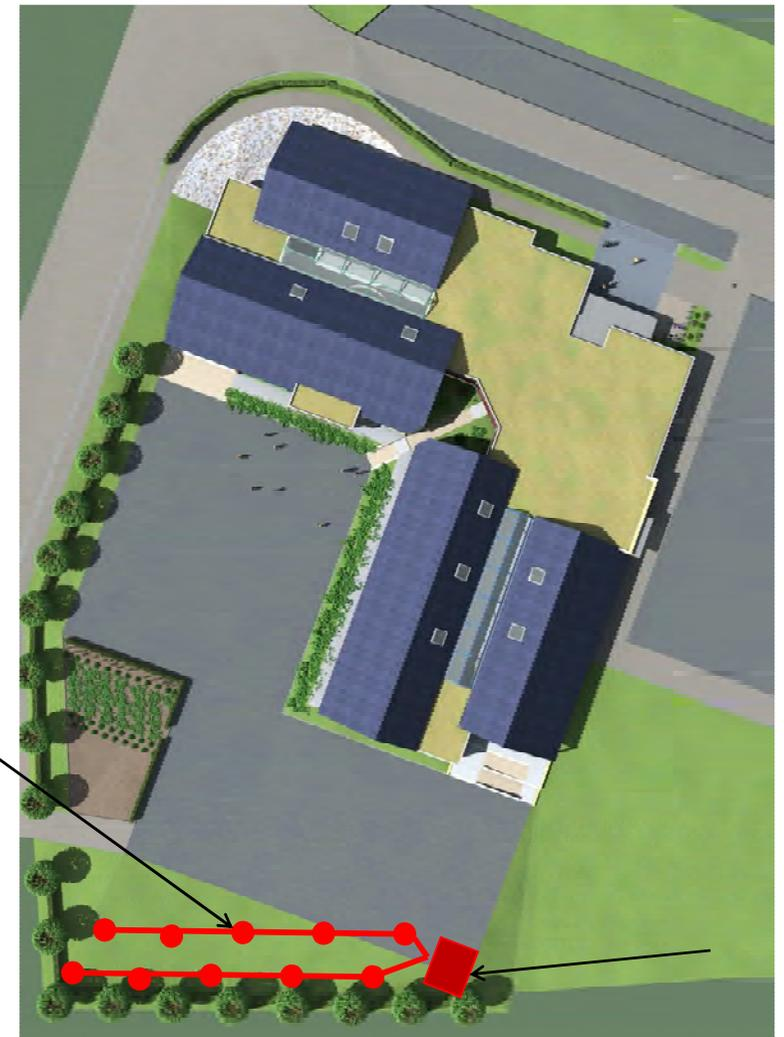
+ Géothermie sur 8 puits profonds entre 120 et 140m
