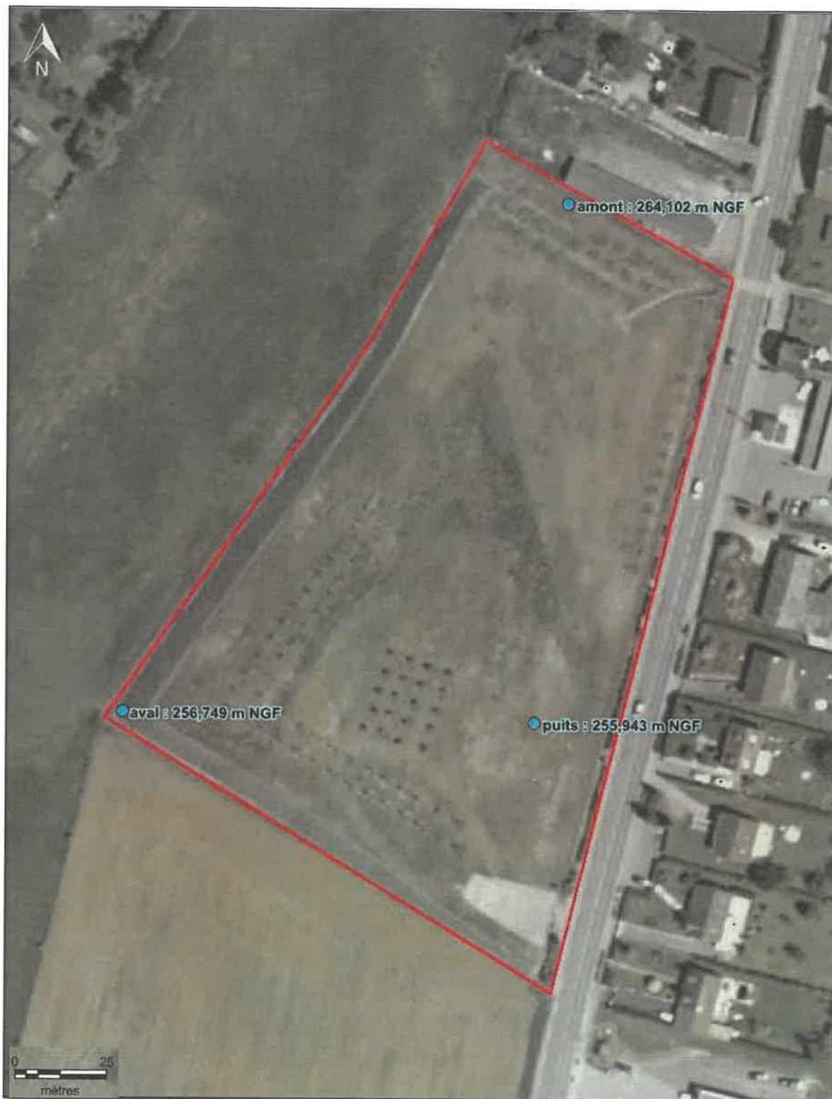
Figure 14 : Niveaux d'eau mesurés sur les ouvrages présents dans la zone d'étude
